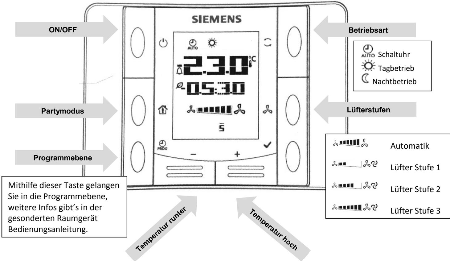
Mit den 2 Tasten Temperatur runter/ hoch kann der Temperatursollwert kurzfristig geändert werden, Anschließend mit ✓ Bestätigen. Sollwertverschiebung (+/- 5K)
