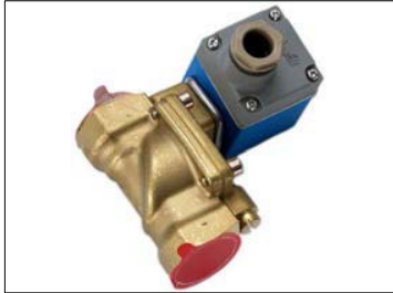
2/2- Wegeventil Danfoss Typ EV 220 B DN 15 – 50 NC Minstdifferenzdruck 0,1 bar
