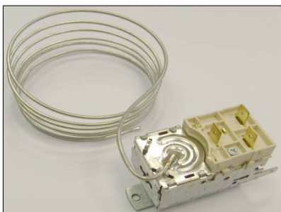
Frostschutzthermostat Anschluss 3 - 2 öffnet bei steigender Temperatur Anschluss 3 - 4 schließt bei steigender Temperatur
